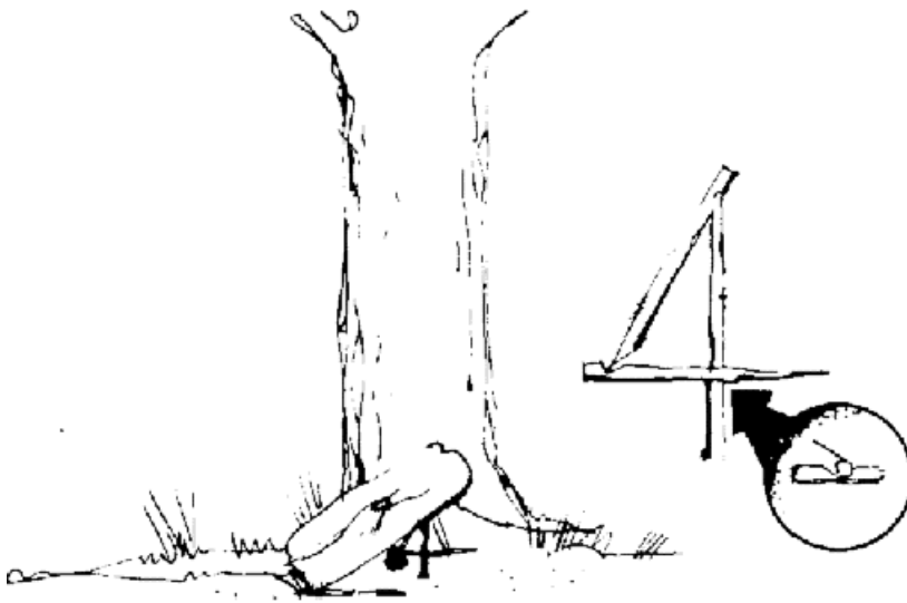
Armadilha por queda simples usando um disparador em «4»
